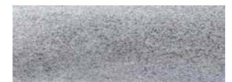
有涂层，工艺后，无明显裂纹
